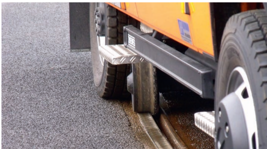
Abb. 3: Beim Antrieb der Kategorie 9C führen die Schienenräder das Fahrzeug durch die Kurve, die Gummiräder beschleunigen und bremsen im eingedeckten Bereich.
