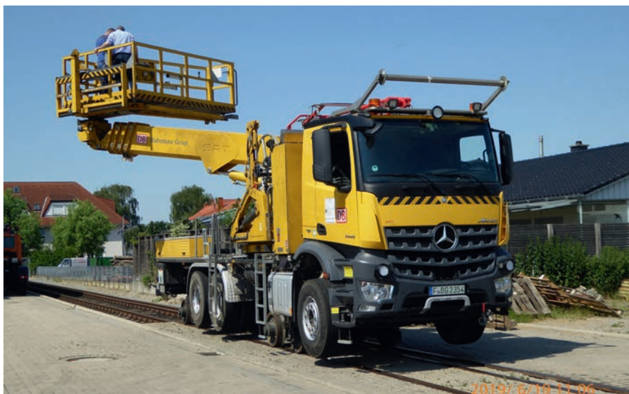
Abb. 2: Das Fahrzeug mit der Hubarbeitsbühne beispielsweise für Oberleitungsarbeiten benötigt einen eingedeckten Bereich, um einzugleisen. Es gehört zur Kategorie 9A.
