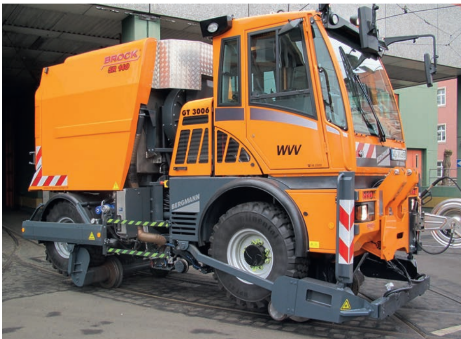
Abb. 1: Der Rillenreiniger verfügt über einen Reibradantrieb (Kategorie 9B).
