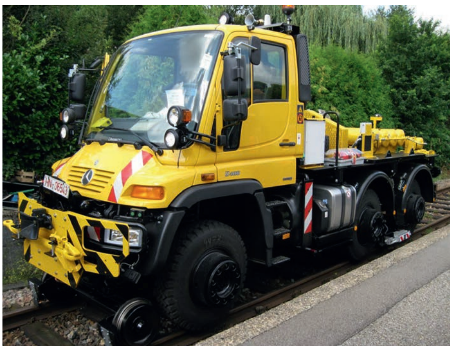
Abb. 4: Ein Zweiwege-Unimog ist durch seine Vielzahl an verschiedenen Auf- und Anbauten eine Art Alleskönner.
